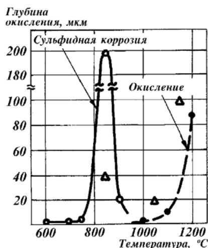
Рис.1. Зависимость глубины высокотемпературной коррозии покрытия Ni20Cr12AlY от температуры испытаний: (о) - лабораторные испытания, 200 часов; (Δ) - испытания на лопатках турбин, 100 часов.
